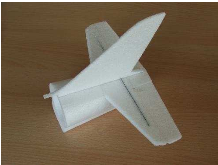
Na zadní část trupu přilepit výškovku a směrovku.
