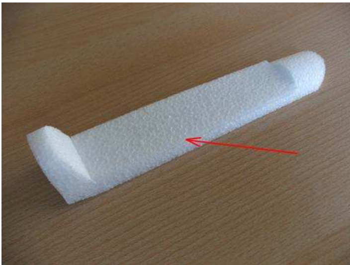
Na odnímací část kabiny přilepit EPP destičku.
