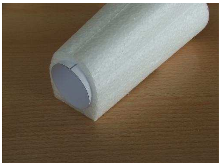
Papírovou trubku vložit a zalepit do zadní části trupu
