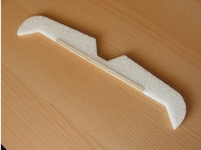
Na pohyblivou část výškovky přilepit výztuhu z balzy 8x4 mm.
