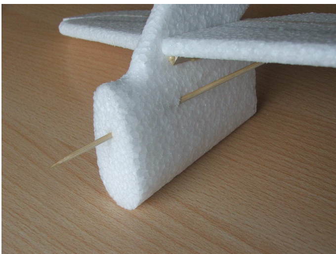
Provrtat otvor pro táhlo výškovky
