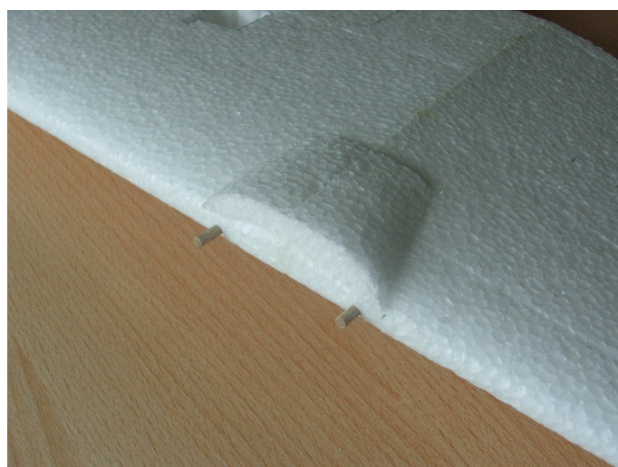
Zalepit dva dřevěné kolíky. Na střední spodní část křídla nalepit odřezanou část trupu.
