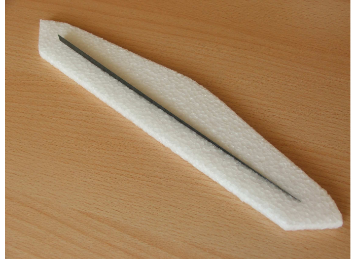
Pevnou část výškovky proříznout a vložit uhlíkový pásek 8x 0,3 mm.
