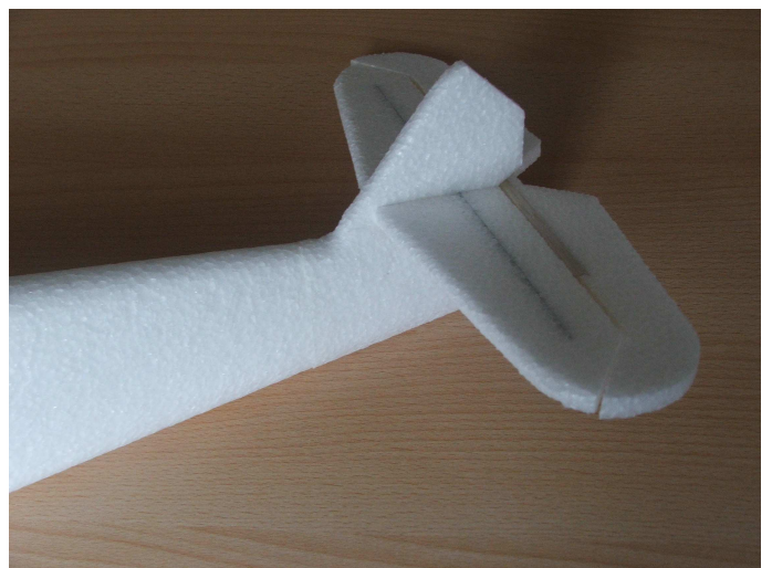
Slepit zadní část trupu.
