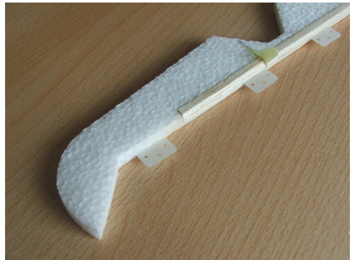
Vyříznout zářezy pro panty. Vyříznout zářez pro ovládací páku a páku zalepit.
