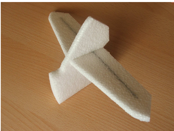
Pevnou část výškovky přilepit na poslední díl trupu. Přilepit pevnou část směrovky.
