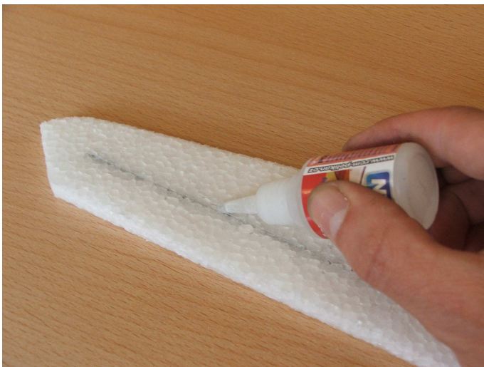
Výztuhu z uhlíku zalepit vteřinovým lepidlem
