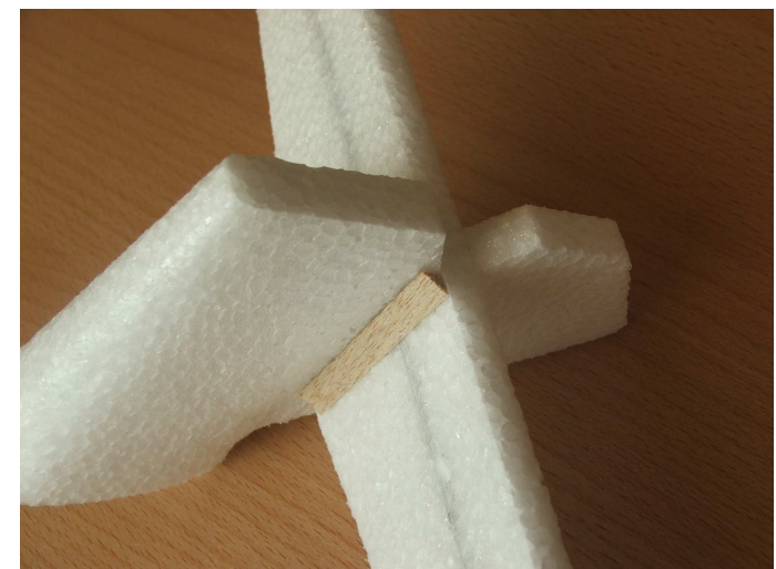
Nalepit výztuhy z balzy trojúhelníkového průřezu.
