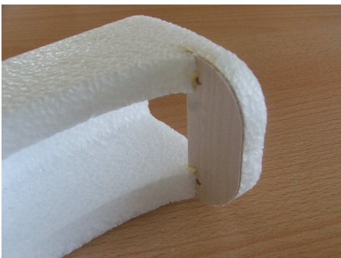
Pro zalepení předního překližkového dílu zhotovit zářez do trupu.
