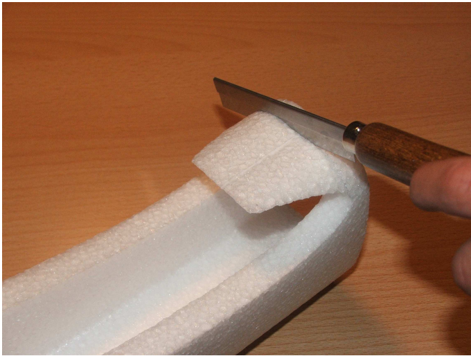
Odříznout spodní část středního dílu trupu.
