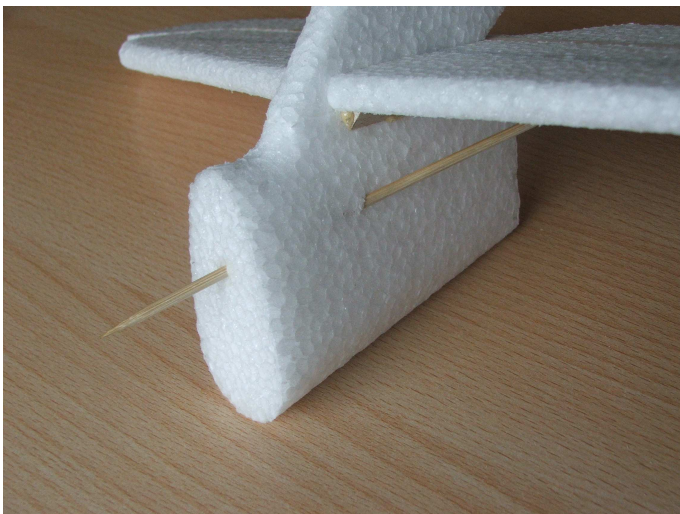
Provrtat otvor pro táhlo výškovky
