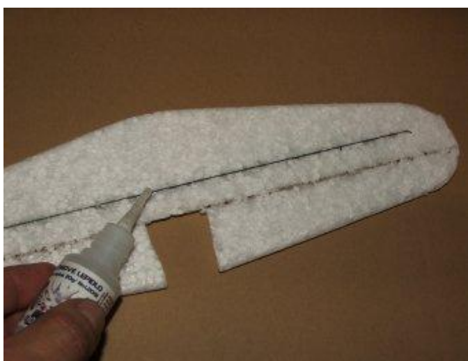
prořízneme drážku a zalepíme uhlíkový pásek
