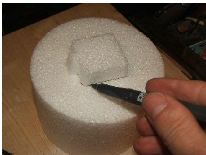
Slepit přední část trupu. Vnitřní kuželovou část vysunout co nejvíce dopředu. Označit polohu.
