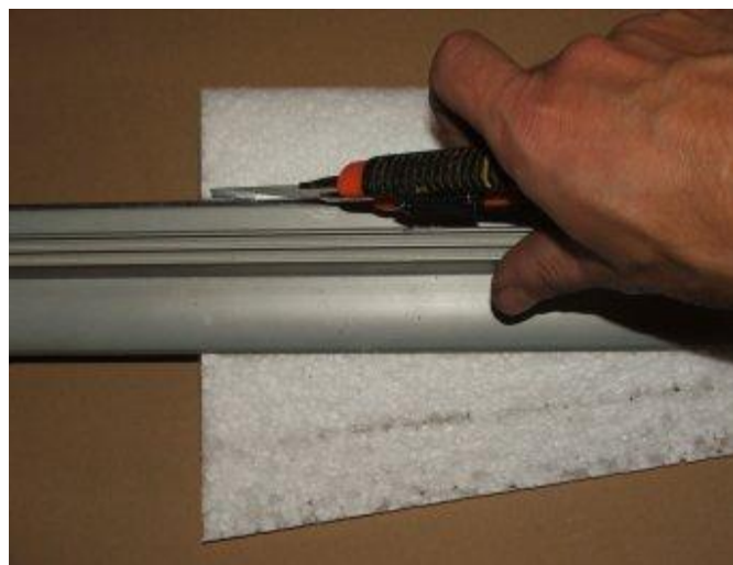
6) ostrým nožem zaříznout zárez pro uhlíkový pásek
