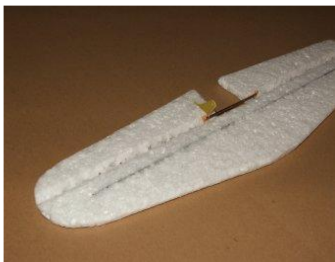
poloviny kormidla spojíme drátem ohnutým do „U“ Do vyřízlé drážky zalepíme vteřinovým lepidlem ovládací páku.
