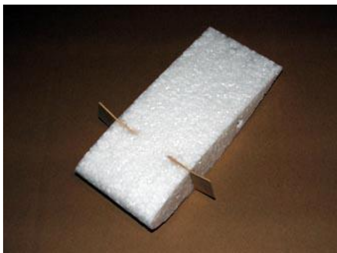
4) do střední části zalepit překližkové spojky křídla
