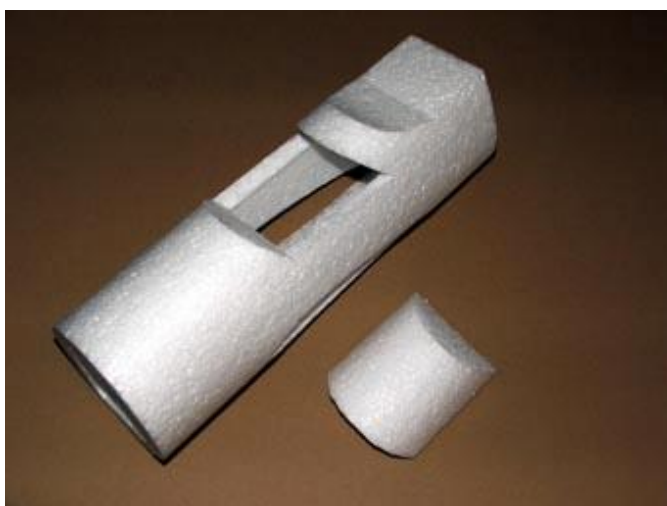
9) odříznout odnímací kryt
