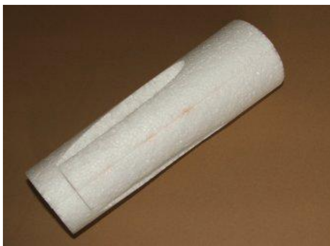
10) slepit prořízlou spodní část trupu
