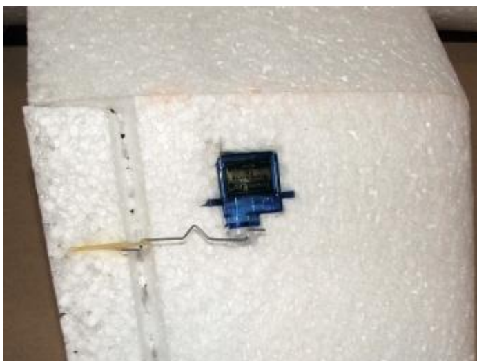
21) táhla kormidel vytvarujeme z ocelového drátu
