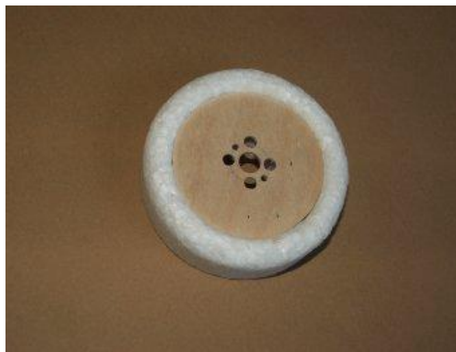
14) vyvrtat otvory dle motoru a zalepit motorovou přepážku
