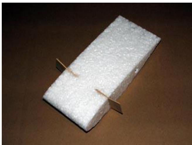
4) do střední části zalepit překližkové spojky křídla
